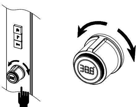
Регулировка температуры воды осуществляется вращением ручки регулировки температуры воды (2). Подача холодной воды осуществляется при повороте ручки влево (против часовой стрелки), горячей - при повороте ручки вправо (по часовой стрелке).
