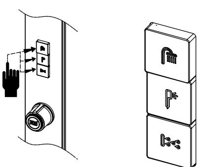
Посредством нажатий/повторных нажатий кнопок включения/выключения верхнего душа(5), ручного душа (4), гидромассажа (3) переключайте потоки воды в соответствии с Вашими предпочтениями.
